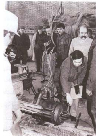
آزمایش گیرداری میلگرد با گروت در بتن با نظارت مسئولین مشاور چویدا
